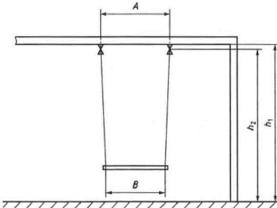
de maximale hoogte van de schommel moet minder dan 60 cm zijn en de minimale hoogte van de grond is 35 cm
