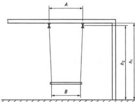
A altura máxima do baloiço deverá ser inferior a 60 cm, e a altura mínima a partir do chão é de 35 cm .
