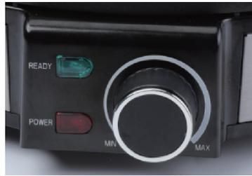
La luz roja es el indicador de alimentación, y la luz verde es el indicador de estado de funcionamiento. Al encender el aparato, las luces rojas se iluminarán a la vez, luego gire el mando para ajustar la temperatura. La luz verde se encenderá y cuando se alcance la temperatura de cocción, la luz verde se apagará (significa que el calefactor deja de calentar). La luz roja permanece iluminada todo el tiempo tras el encendido.
