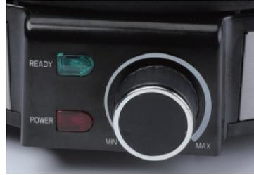
Die rote Leuchte dient als Betriebsanzeige und die grüne Leuchte zeigt den Betriebszustand an. Nach dem Einschalten leuchten die roten Lampen. Drehen Sie den Knopf, um die Temperatur einzustellen. Die grüne Lampe leuchtet auf. Wenn die Temperatur erreicht ist, erlischt sie wieder (das Hezelement schaltet sich ab). Nach dem Einschalten leuchtet die rote Lampe weiter.
